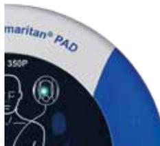
**Figura 11.** LED parpadeando en verde; no se requiere acción.
