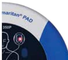
**Figura 10.** Indicador luminoso parpadeando en rojo o pitido; Consulte la sección *Resolución de problemas* en Apéndice B.
