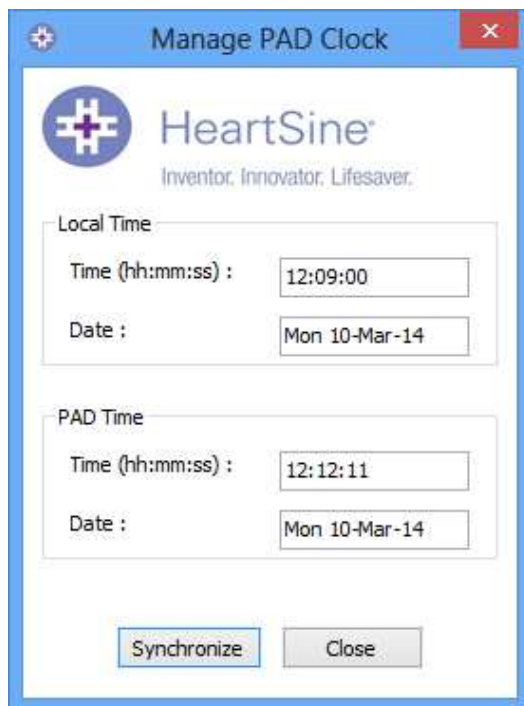
Kontroll / innstilling av Saver EVO PAD-tid
