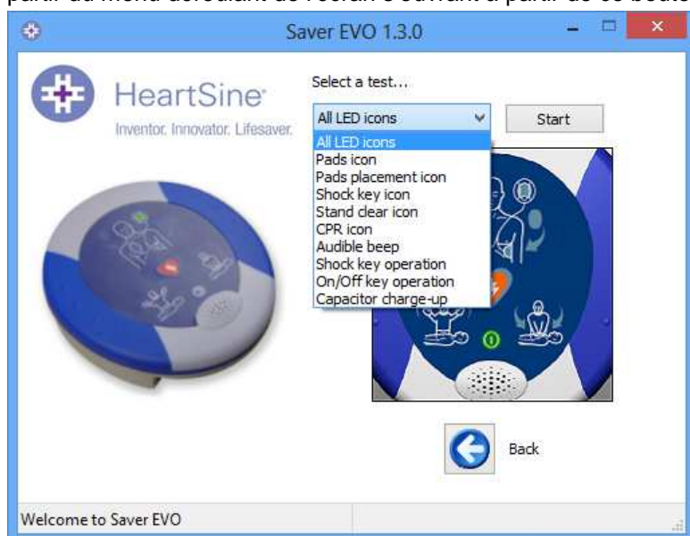
Ecran des tests de diagnostic du PAD sur Saver EVO
