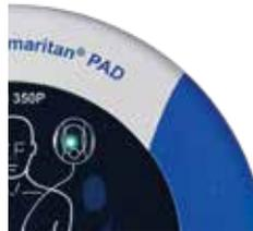
Figura 10. LED parpadeante verde; no requiere acción.
