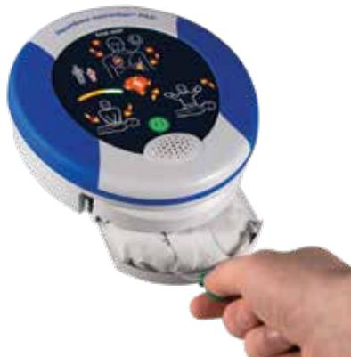
**13. LETAKKAN PAD ELEKTROD**
