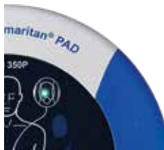
Figur 10. Blinkande grön LED: ingen åtgärd behövs.
