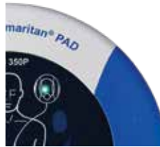
Afbeelding 10. Knipperende groene led, geen actie vereist.
